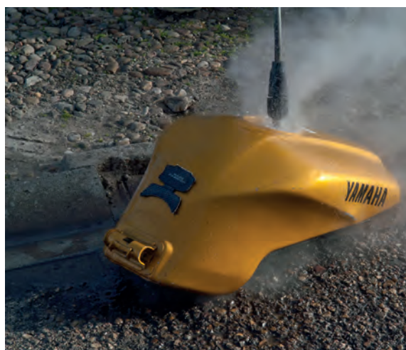
Proceso de desgasificado.
