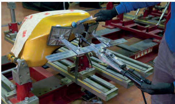
Estiraje del daño mediante el puente.
