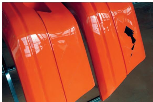
Ensayo de adherencia simulando el lavado a alta presión.
