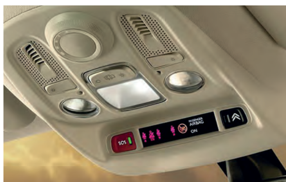
El sistema eCall conecta directamente el vehículo con los operativos de emergencia.
